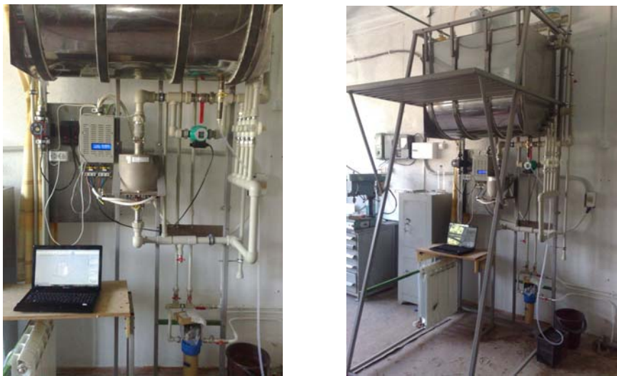
Рис. 1. Загальний вигляд установки для дослідження теплоакумулятора
